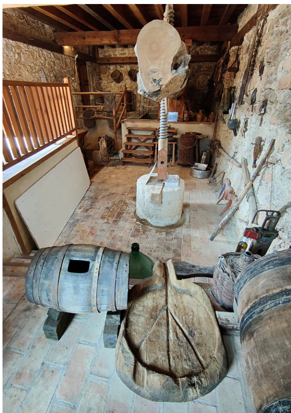
Figura 17. “Lagar” tradicional de San Miguel a San Esteban de Gormaz (Sòria). Es pot observar com algunes parts d'aquesta premsa (la biga o el jaç) estan fetes de fusta, un material efímer que no acostuma a deixar empremta arqueològica. Molt probablement, la producció d'oli o vi no ha pogut ser identificada en alguns jaciments protohistòrics perquè les instal·lacions estarien fetes en aquests materials (Carme Belarte).
